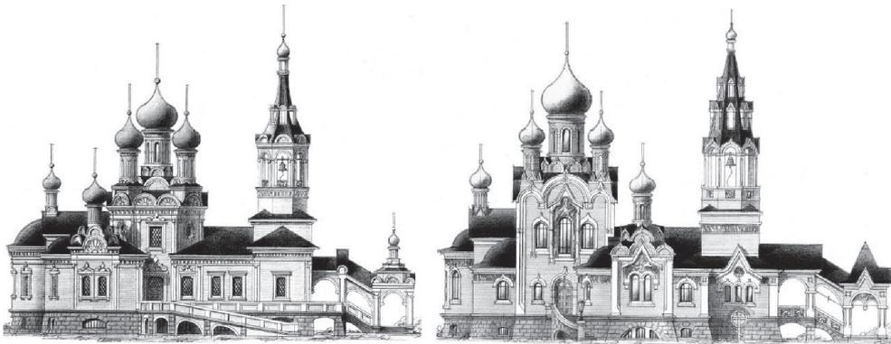
**Рис. 3. Храмы, предусматривающие поэтапное возведение структурных элементов.<sup>6</sup>**
