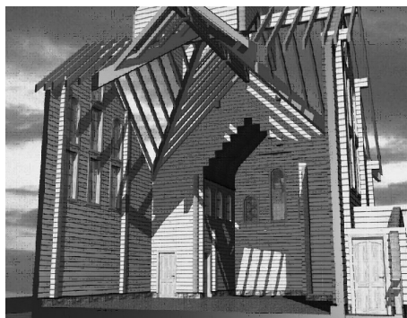
Конструктивная схема храма
